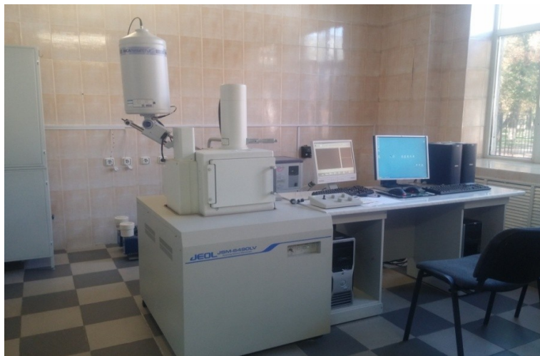
Сурет 2. JSM-6490LV расторлы төменвакуумды электронды микроскоп
