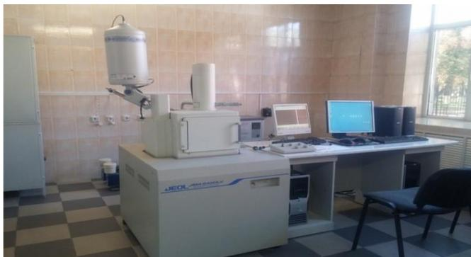
Сурет 15 - JSM-6490LV расторлы төменвакуумды электронды микроскоп
